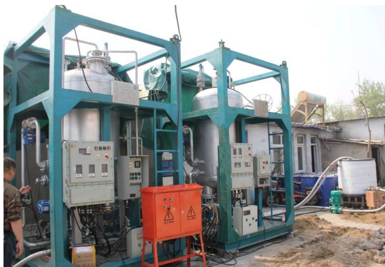
图 新型复合高效油水分离与计量装置（中国船级社认证）
