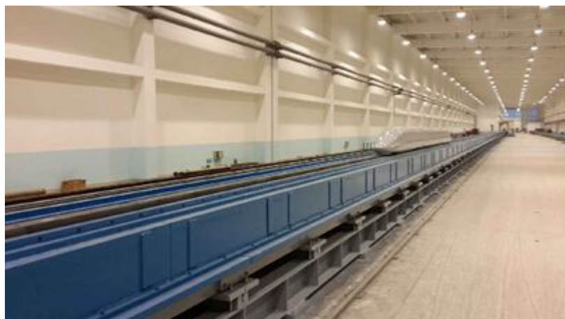
图 1 高速列车动模型试验平台
