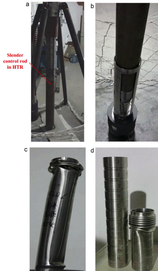
图 4 原型验证实验 a) 模型试验中的细长控制棒 b) 控制棒冲击梯度缺陷筒 c) 完整筒受控制棒冲击发生欧拉失稳 d) 梯度缺陷筒的圆环形屈曲模式
