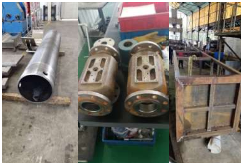
图 2. 从左至右分别是：加工中的计量管主体，电控液压三通阀主体，仪器整体撬架
