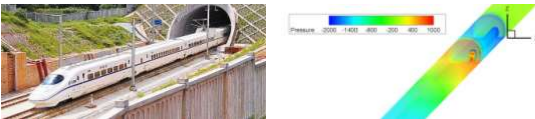
图 3 列车通过隧道与隧道压力波
